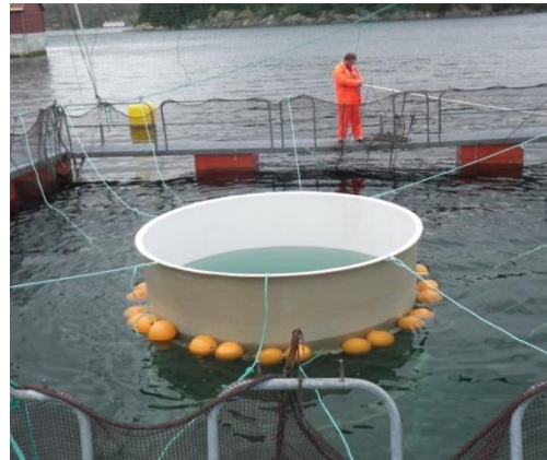
Mynd 5.7.4. Hólkur (snorkelmerd) í miðri kví festur í netþak tengt við netpoka sem kemur í veg fyrir að eldisfiskur komist upp í sjávaryfirborð nema upp um hólkinn ( http://lusedata.no ).
