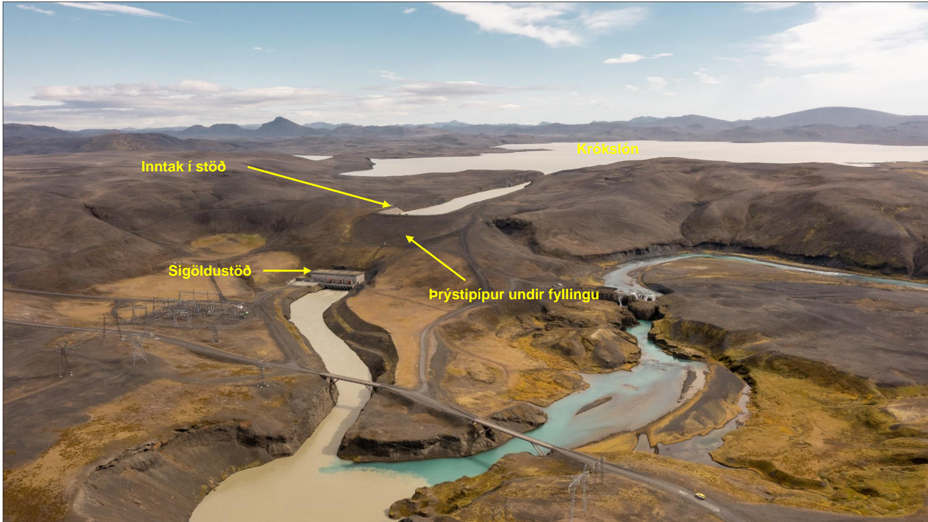
Mynd 2.4 Yfirlitsmynd af Sigöldustöð og nágrenni. Til hægri má sjá hvar yfirfallsvatn rennur um Sigöldugljúfur.
